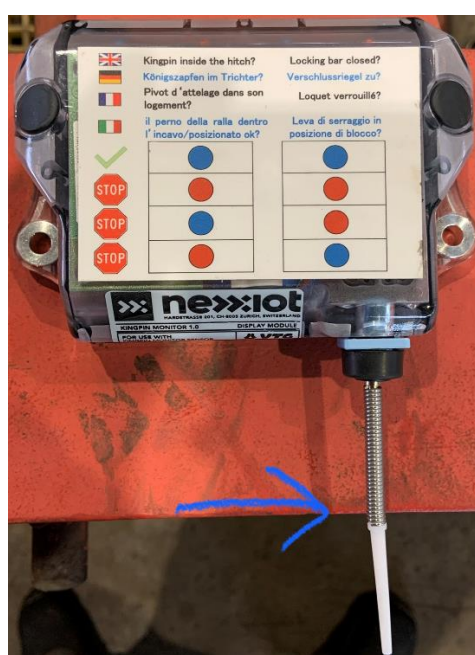
Bild 8.2: Schalter zum Aktivieren des Sensors aus dem Standby-Modus
