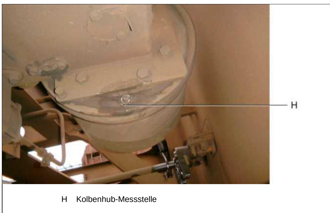
Bild 6: Pfropfen am Bremszylinder – Stelle für Kolbenhubmessung
