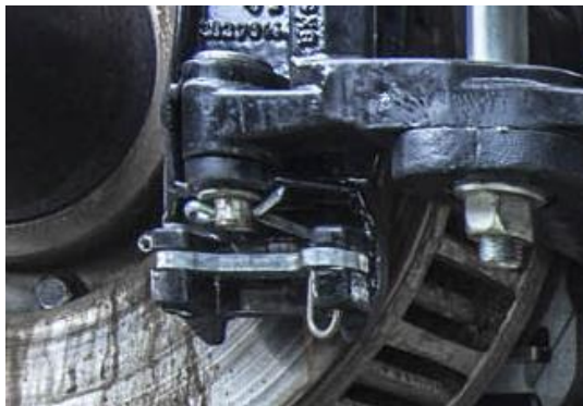
Bild 8: Verschluss am Belaghalter Knorr bzw. DAKO
