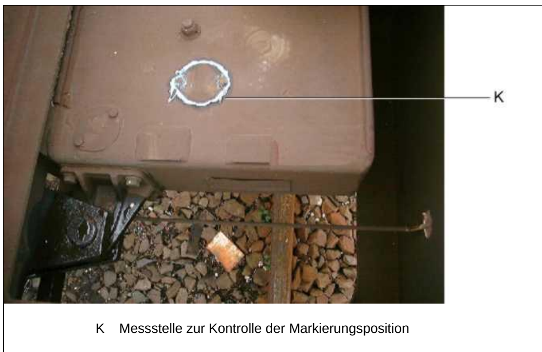
Bild 5: Deckel (Pos. 126) - Messstelle zur Kontrolle der Markierungsposition
