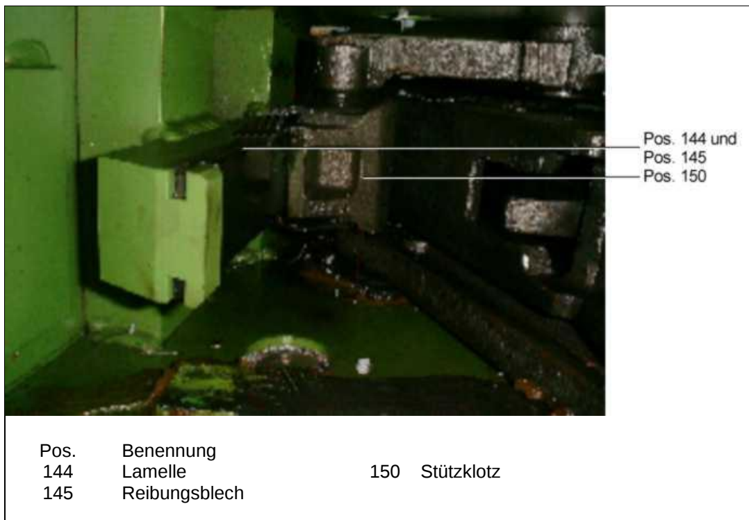
Bild 4: Ansicht der nicht zu schmierenden Teile (Lamelle, Reibungsblech, Stützklötz)
