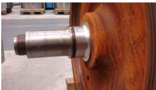
Bild 4: gedrehter Notlaufschenkel und Übergangsradius
