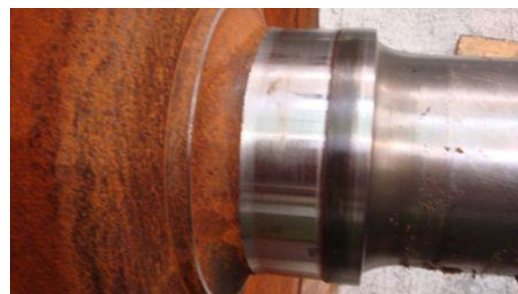
Bild 5: gedrehter Notlaufschenkel ohne Radius
