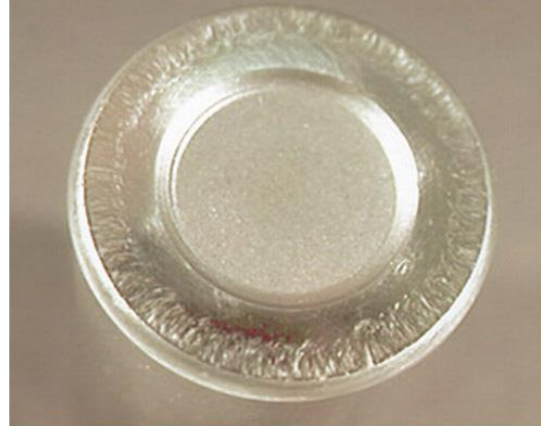
Bild 11: Zykloidförmige Fressspuren an der Stirnseite einer Zylinderrolle
