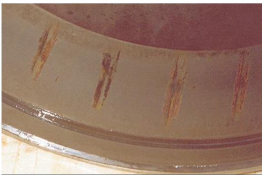
Bild 8b: Rostnarben an Laufbahn
