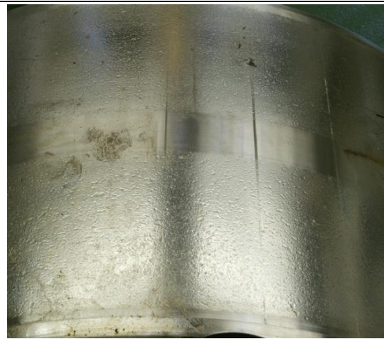
Bild 6: Eindrückungen an der Laufbahn des Innenringes
