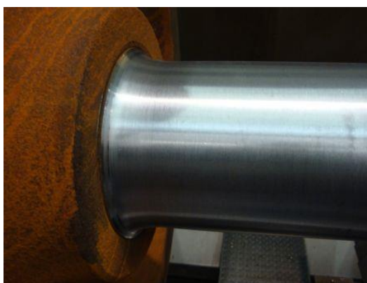
Bild 1: gedrehter Wellenschaft mit Korbbögen ohne Überstand
