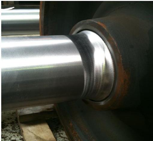
Bild 3: gedrehter Wellenschaft mit Korbbogen mit Überstand
