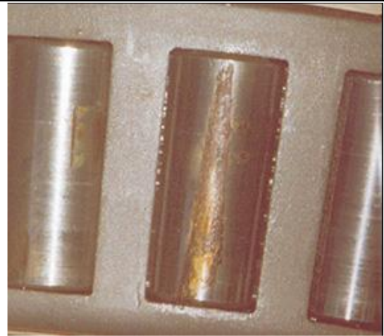
Bild 8a: Rostnarben an Zylinderrolle
