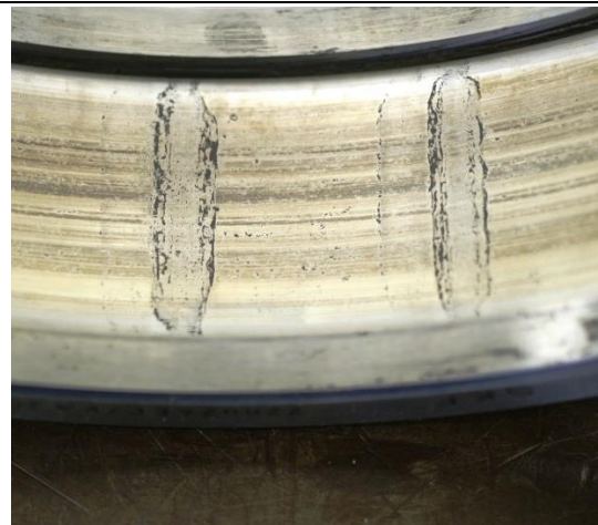
Bild 9: Rostnarben am Innenring eines Pendelrollenlagers durch Wasser verursacht
